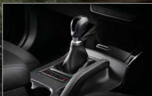
6stupňová manuální převodovka Manuálně řazená 6stupňová převodovka zajišťuje přenos vysokého točivého momentu při razantním zrychlování a rychlé jízdě spolu s hladkými změnami převodů a hospodárným provozem.
