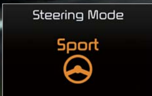
Řízení FlexSteer Vybírat lze ze tří přednastavených režimů upravujících odezvu řízení a ovládací síly podle různých podmínek: Normal pro běžný provoz, Comfort pro pohodlné cestování po městě či parkování a režim Sport pro přímější kontakt řidiče s vozovkou. Standard u verzí s manuální převodovkou.
